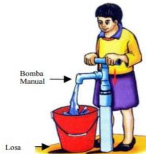
*Figura N°10: Pozos con bombas manuales*
