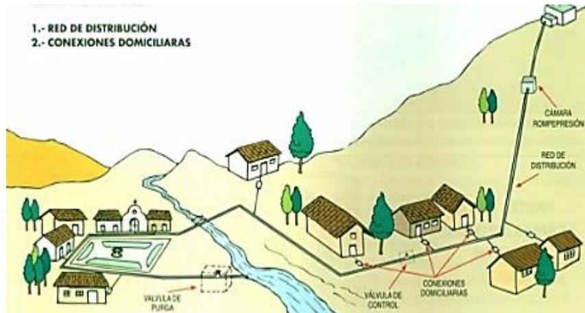
*Figura N°4: Sistema abastecimiento de agua por gravedad con tratamiento.*
