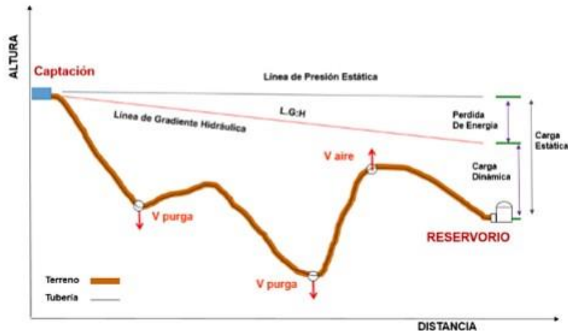
Ilustración N° 03.31. Línea de Conducción
