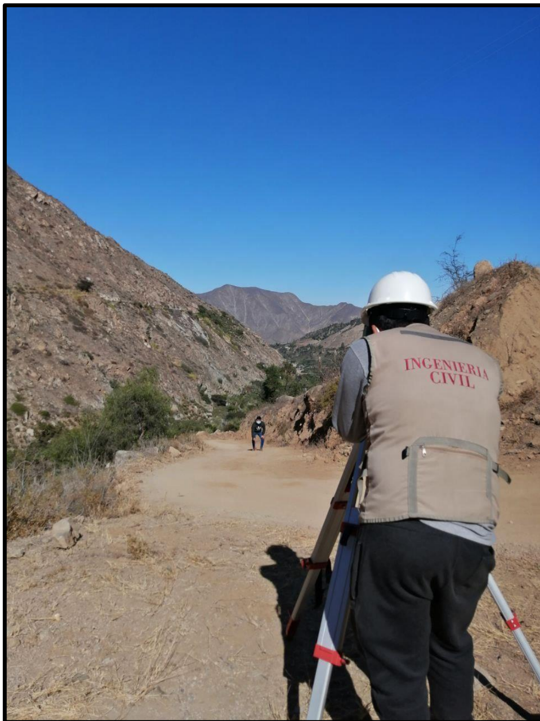
Imagen N°5: Se observa el levantamiento topográfico del recorrido del sistema de abastecimiento de agua potable de la localidad Acllahuain, La Libertad, Huaraz, Áncash
