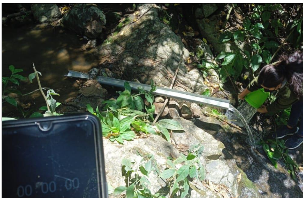
IMAGEN 2. Foto del Aforamiento Manantial El Citán - Aforo Método Volumétrico.
