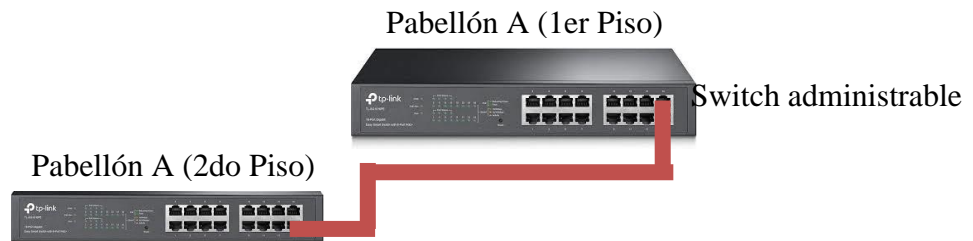
Gráfico Nro. 20: Plano de conectividad de switch de 2do Piso – Pabellón A
