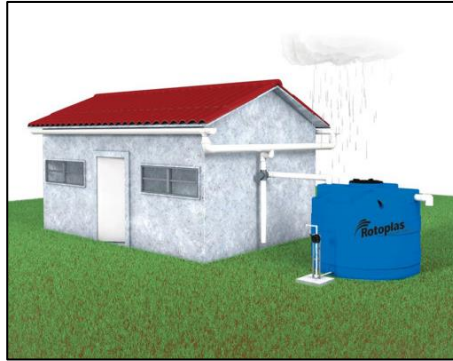
Figura 4 Captación de fuente pluvial
