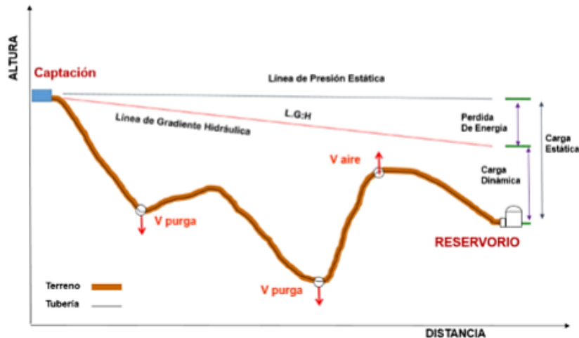
Ilustración N° 03.31. Línea de Conducción
