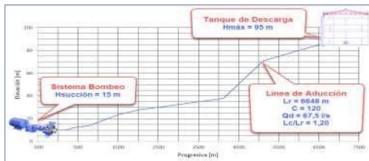
imagen 18 línea de conducción por bombeo
