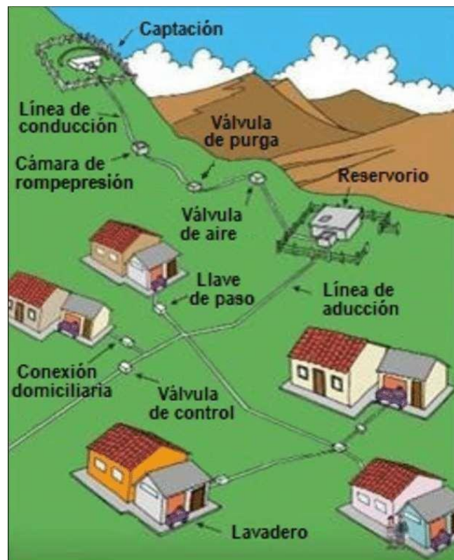
imagen 3 Sistema de agua potable por gravedad
