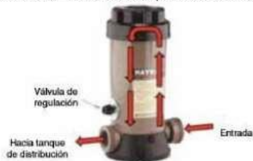
Ilustración N° 03.58. Dosificador por erosión de tableta
