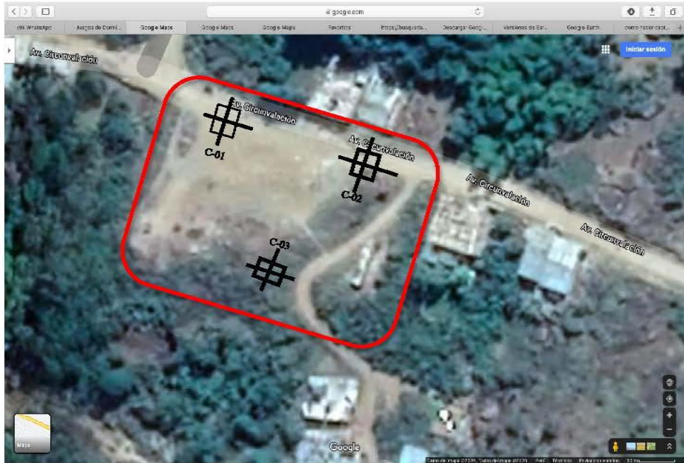
Ilustración 1 PLANO DE UBICACIÓN DE CALICATAS (REFERENCIAL)
