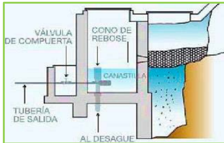
Figura N°2: Captación de ladera.
