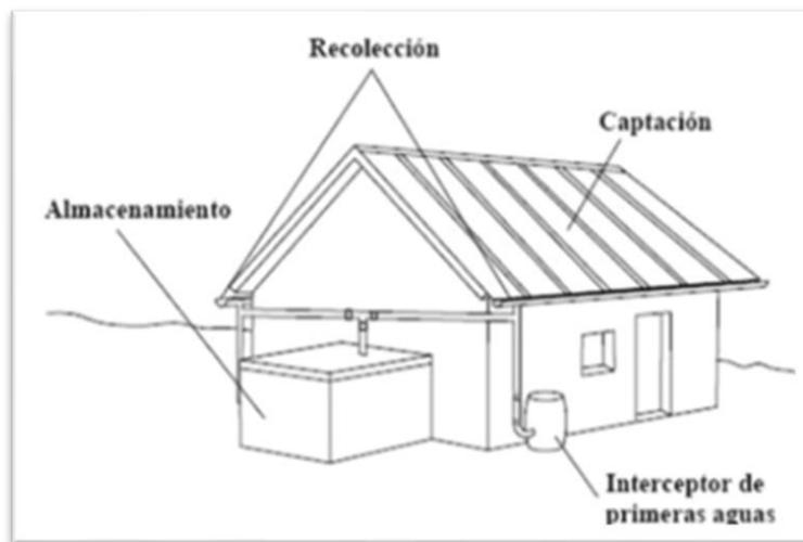
**Imagen 6:** Captación de agua de pluvial
