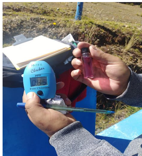
Imagen N° 35: Resultados de la presencia de cloro
