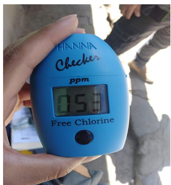
Imagen N° 36: Resultados de la presencia de cloro
