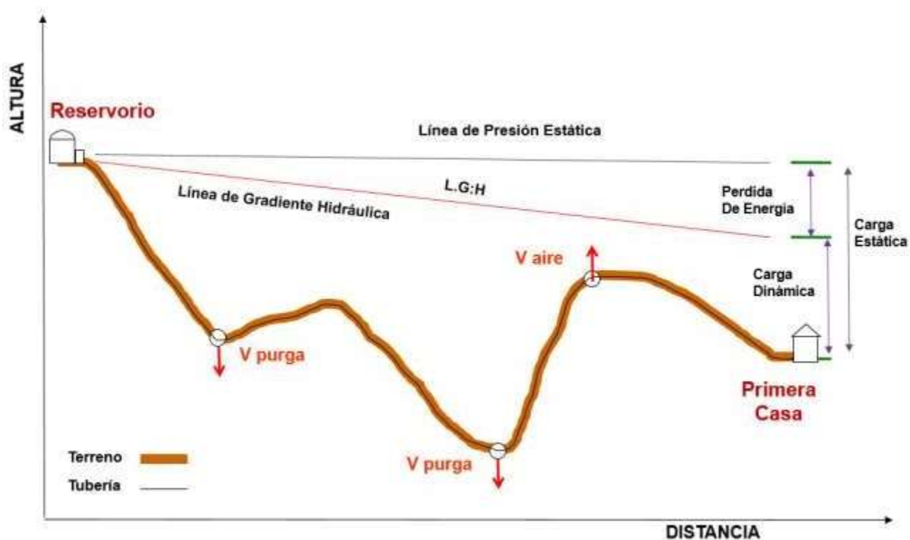
Imagen N° 10: Línea de aducción.
