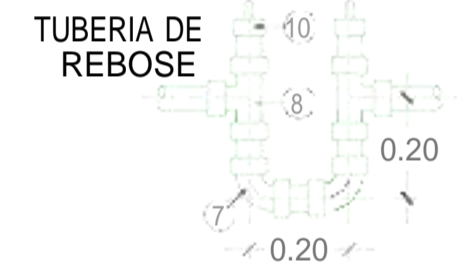
DETALLE DE SELLO HIDRÁULICO ESCALA : 1/10
