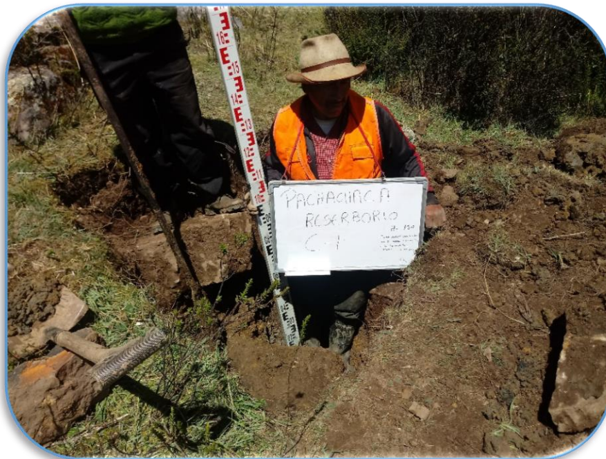
Figura 14: Se muestra la excavación de la calicata a una profundidad de 1.50 m y extracción de la muestra alterada en bolsa del suelo, para el análisis en laboratorio.
