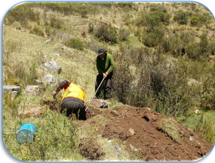
Figura 13: Se muestra la excavación de la calicata a una profundidad de 1.50 m y extracción de la muestra alterada en bolsa del suelo, para el análisis en laboratorio.
