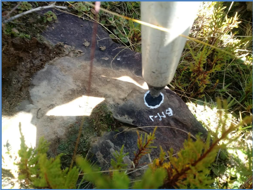
Figura 08: Ubicación del BM-1, que servirá para el replanteo del sistema de agua potable.
