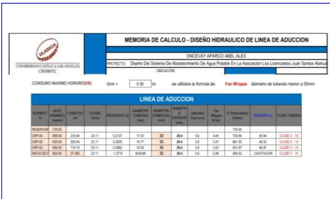
Figura 56: Memoria de cálculo diseño Hidráulico de línea de aducción (a)
