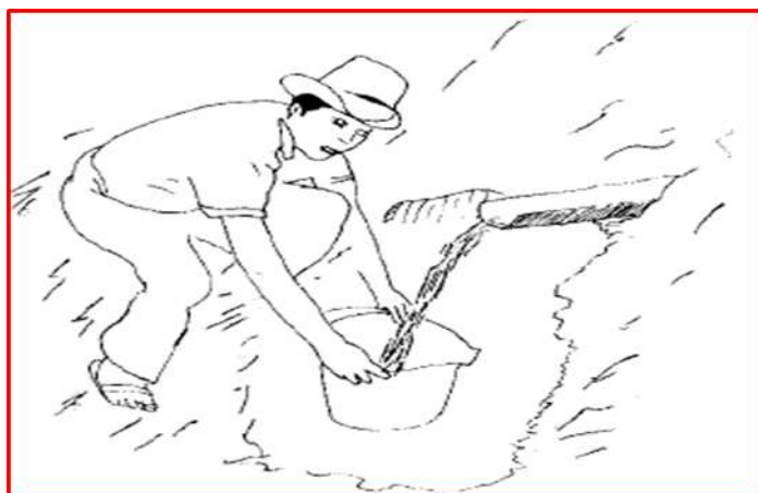
Figura 5:Aforo del agua por el método volumétrico
