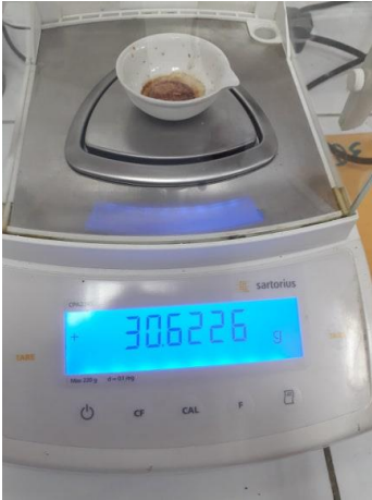
Peso de cápsulas del método de sólidos totales para la preparación del gel al 2% y 4%
