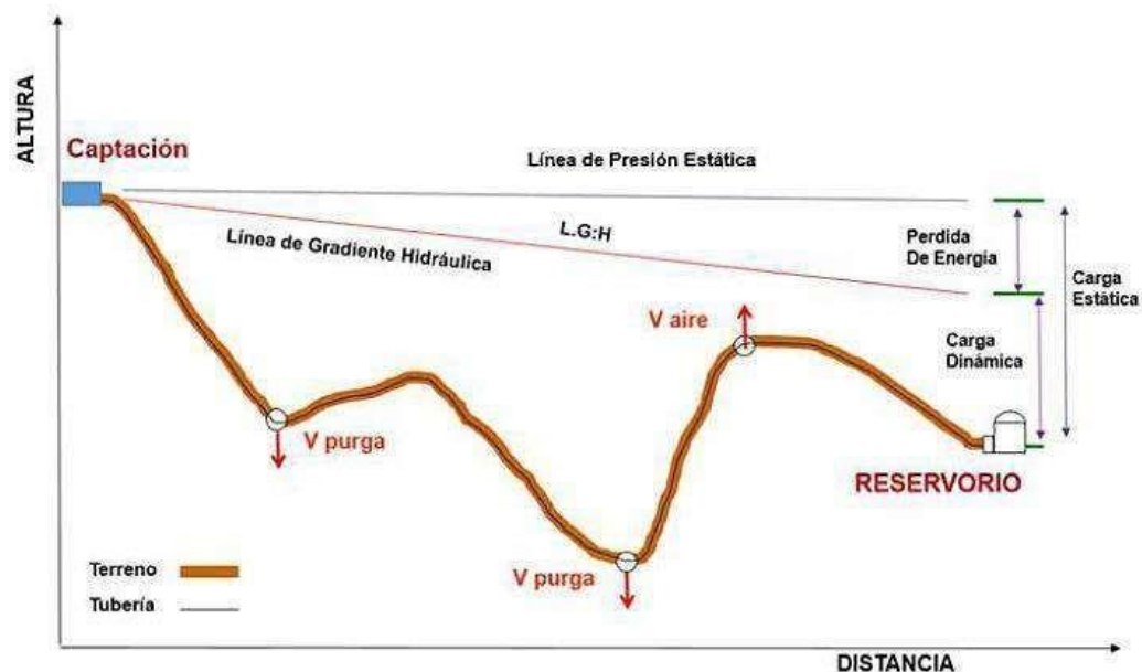
Ilustración N° 03.31. Línea de Conducción
