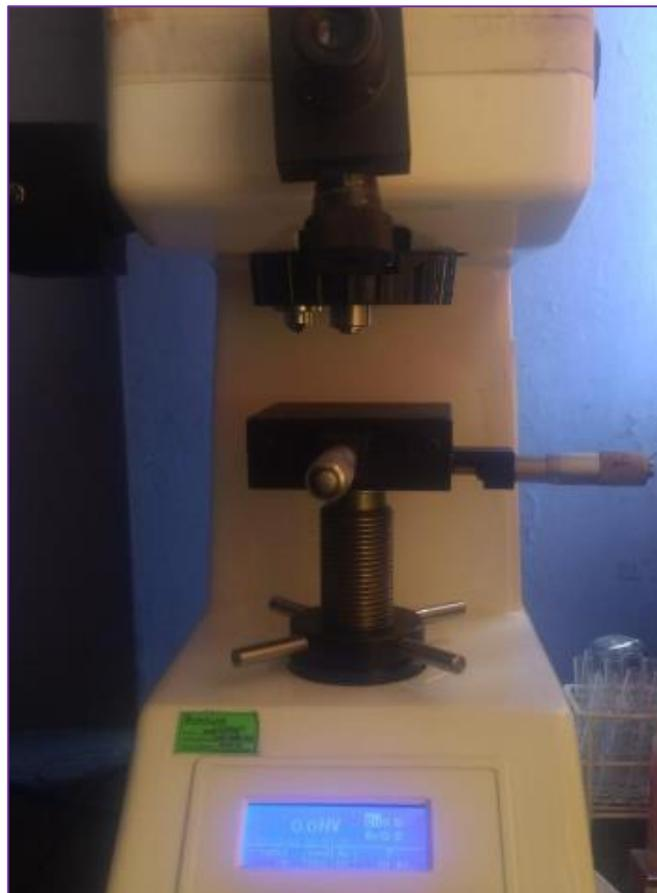
En estas imágenes se ve el momento en el que las resinas están siendo sometidas a la presión y en la parte inferior del Micro durómetro nos indica el valor que obtuvo con cada una bloque cilíndrico de resina.
