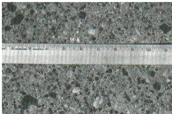
*Figura 13:* Pulimento de agregados.
