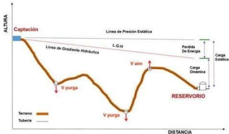
Ilustración N° 03.31. Línea de Conducción
