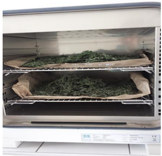
Secado de muestra en estufa a 40°C
