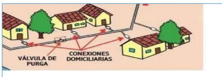
Figura 8 Tuberías principales
