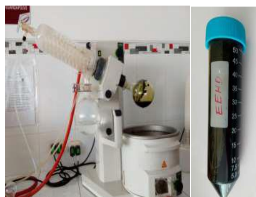
Se llevó el extracto a rota vapor a 40° para eliminar el alcohol.
