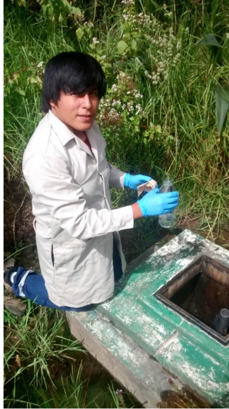
Fotografía N° 05: toma de muestras de la fuente de agua potable
