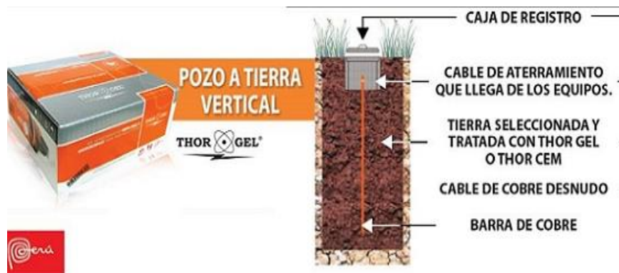
Gráfico Nro. 14: Pozo a tierra vertical
