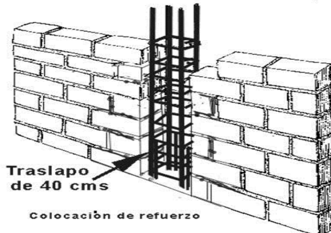
Figura 05. Imagen de columna y muro de albañilería
