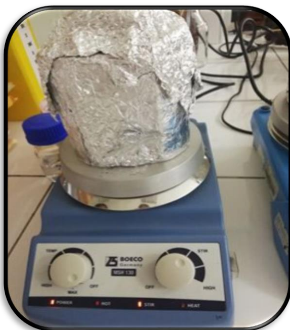
Figura 3: Colocación en el agitador magnético por 30 minutos
