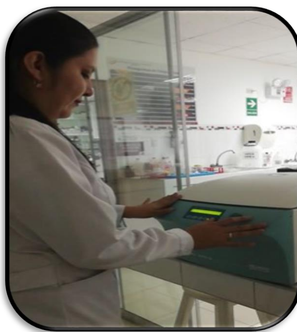
Figura 4: Colocación en la centrifuga a 6000 rpm
