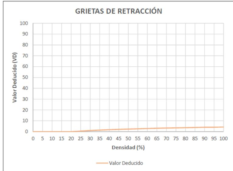
Figura 128: Falla 37 – Grietas de Retracción
