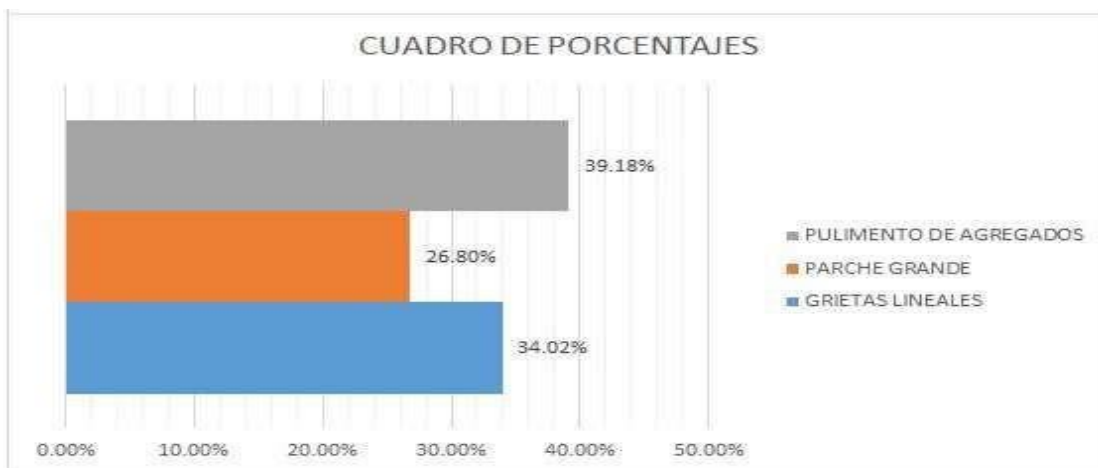
Figura 111: Tipos de Patologías que Afectan la Unidad de Muestra 9.
