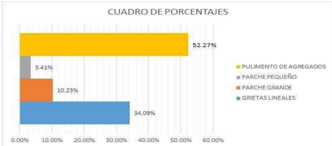
Figura 47: Tipos de Patologías que Afectan la Unidad de Muestra 1.
