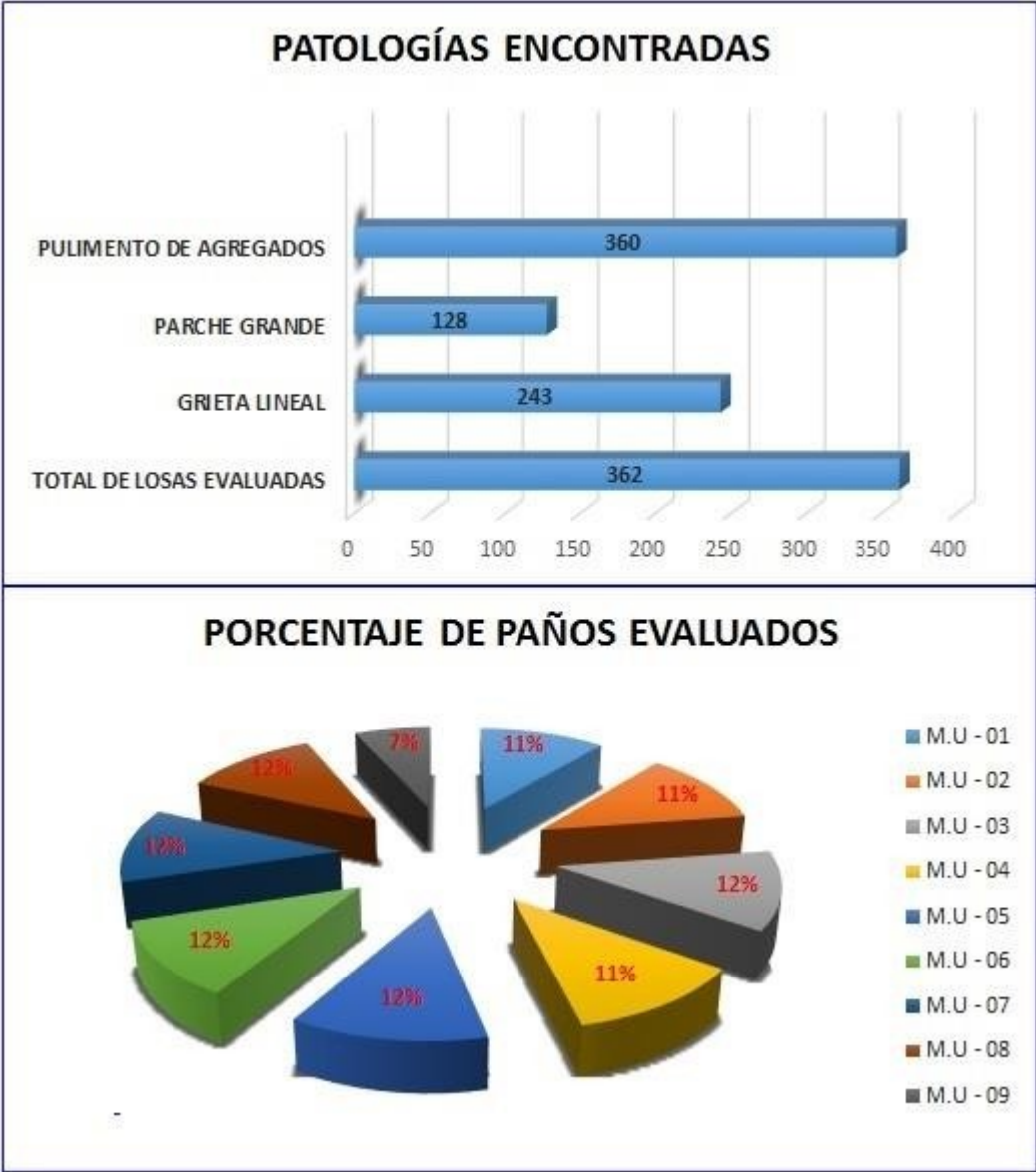
Figura 28. Cantidad total y porcentaje de paños afectados por cada tipo de patología.
