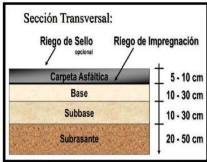
Figura 2. Sección Transversal Pavimento Flexible
