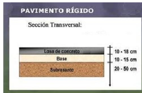
**Figura 01** Paquete estructural, pavimento rígido
