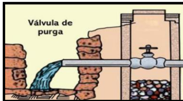
Figura 14. Cámara rompe presión.
