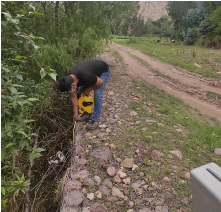
Figura 5.4: Medición del ancho de gavión.
