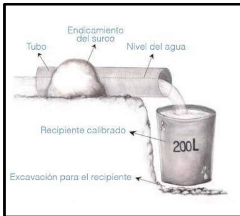
Figura 4: Medición del caudal por el método volumétrico
