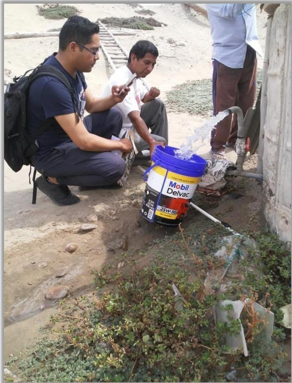
**Fotografía 04:** Método volumétrico para determinar caudal de salida de captación
