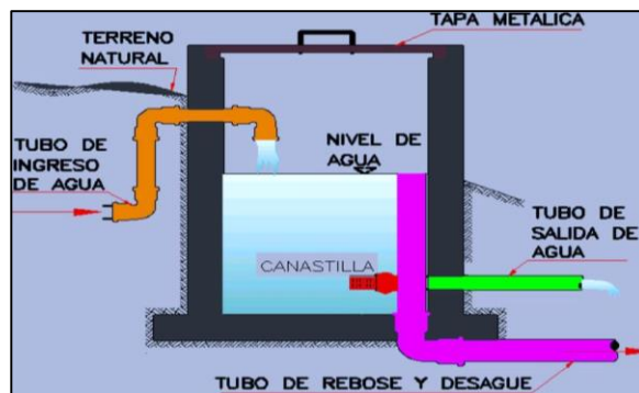
Imagen 12 Cámara rompe presión tipo VI
