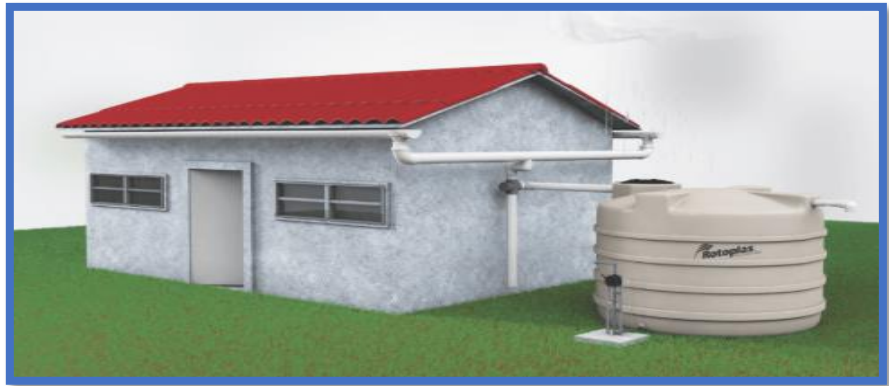
Figura 7. Captación de agua pluvial
