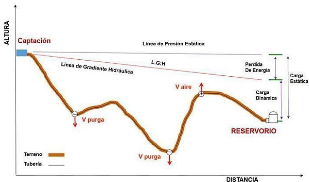
Ilustración N° 03.31. Línea de Conducción
