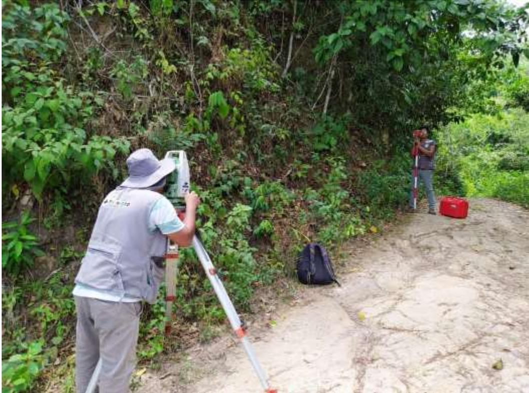
Figura 24. Se muestra el levantamiento topográfico realizado.
