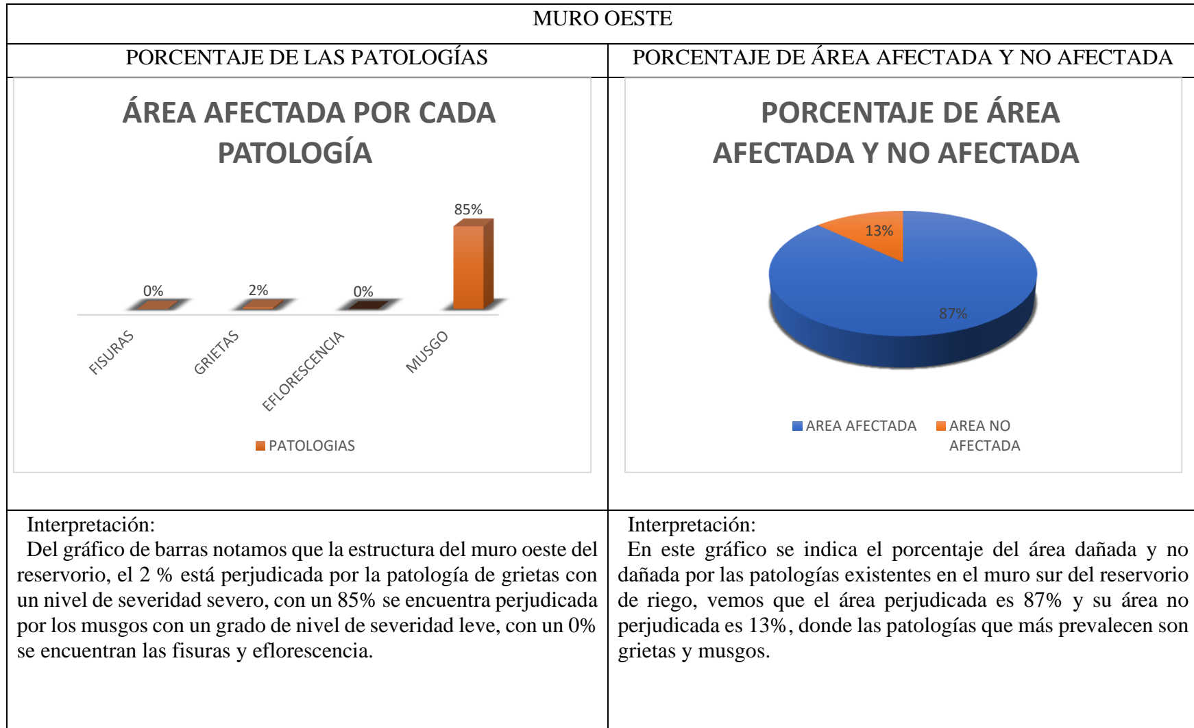
Gráfico 4. Identificación de las patologías en el Muro Oeste de la unidad muestral N° 04.
