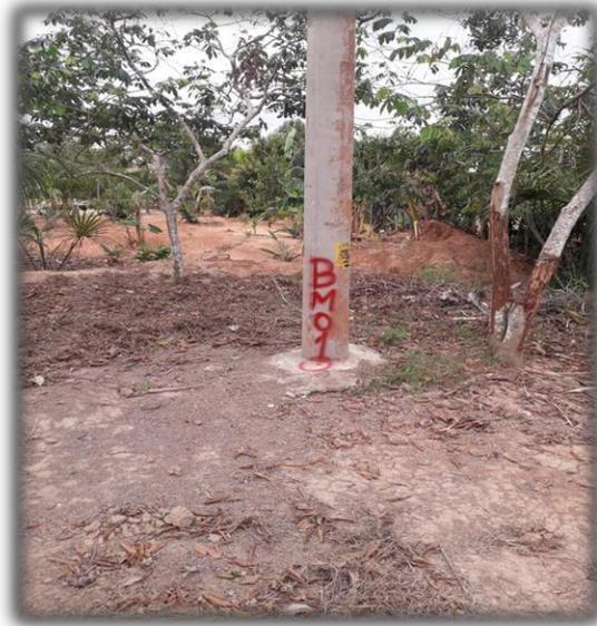
Bm-01, se encuentra ubicado en un poste de baja tensión, dicho punto se encuentra georeferenciado con GPS, además se realizó el pintado con pintura spray de color rojo, tal como se muestra en la toma fotográfica.
