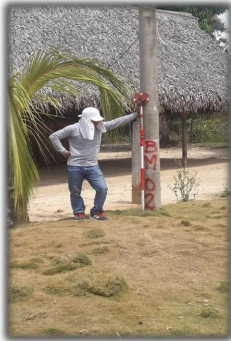
Bm-02, se encuentra ubicado en un poste de baja tensión, dicho punto se encuentra georeferenciado con GPS, además se realizó el pintado con pintura spray de color rojo, tal como se muestra en la toma fotográfica.
