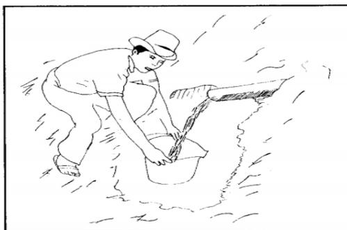
Figura 5: Aforo de agua por el método volumétrico
