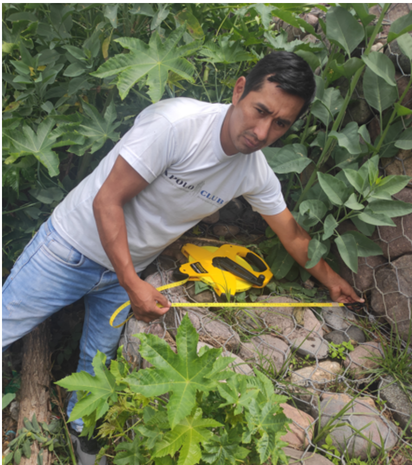
Figura 5.6: Medición de ancho del gavión. Fuente: Elaboración propia.
