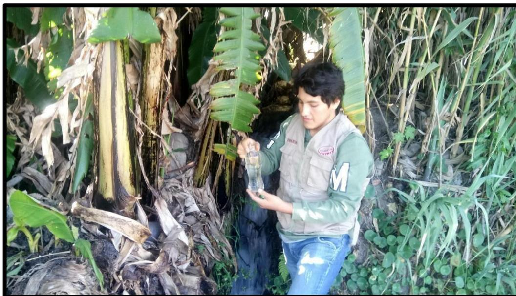
Figura 27. Toma de muestra de agua para el analisis Fisicoquimico del agua
