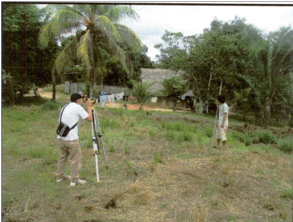
Vista de la nivelación geométrica de los BMS.
