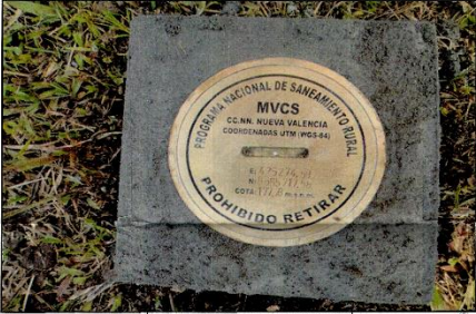
HITO GEOREFERENCIADO COTA: 177.78 msnm N: 9655717.58 E: 425274.59
