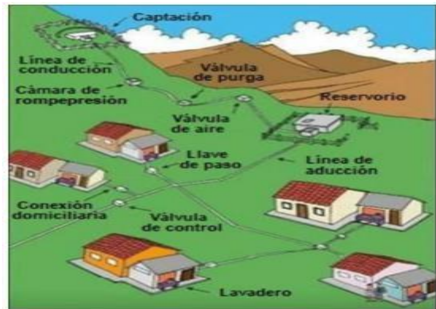
Figura 03. Sistema de agua potable por gravedad
