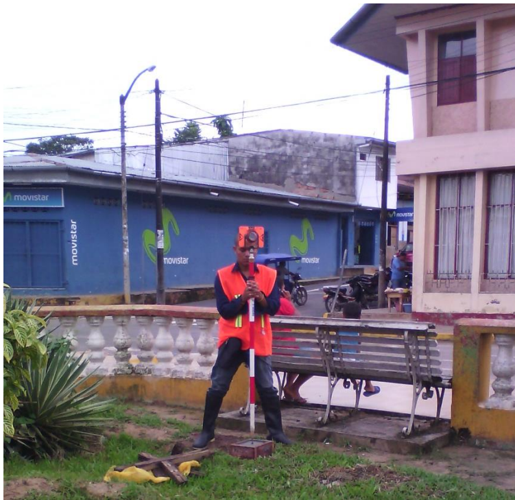
Se observa que la estación total visa al segundo punto geodésico tomado con el GPS Diferencial, para la corrección en planimetría y altimetría.
