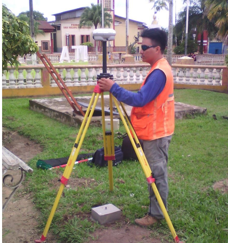
Se observa la toma de datos y el referenciado de los BM's Principales
