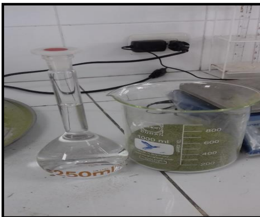
4. Método de percolación simple para la eliminación de impurezas en el polvo.
