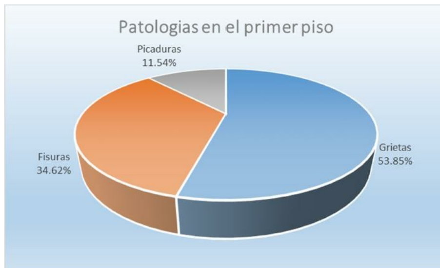
Figura 121. Resumen de patología del primer piso
