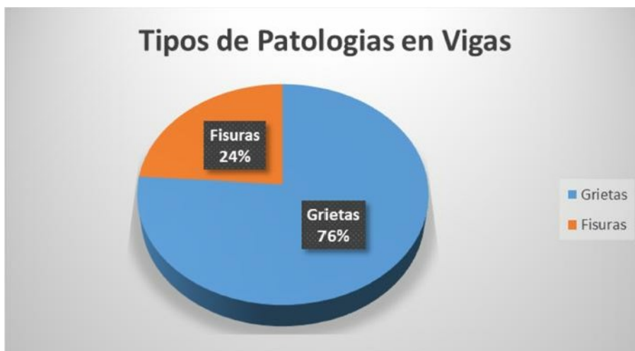
Figura 100: Tipos de patología en las vigas - primer piso
