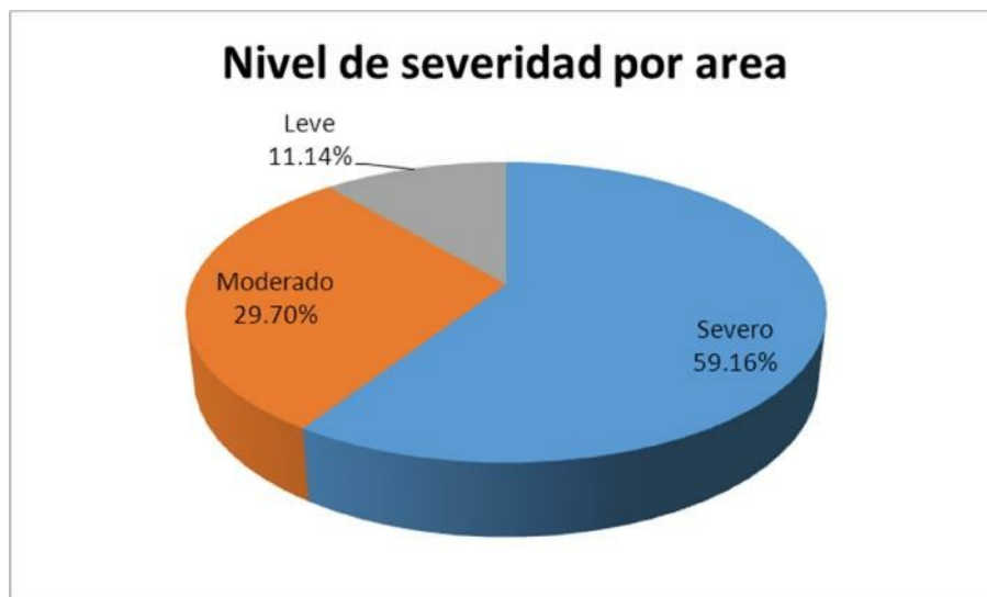
Figura 111. Área de severidades de las vigas – segundo piso.
