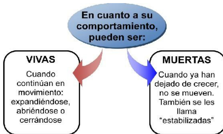
Figura 68, Clasificación de las fisuras en cuanto a su comportamiento.
