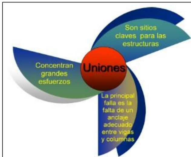
Figura 56, Esquema de las uniones vigas - columnas
