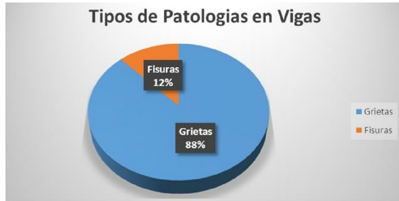
Figura 107. Tipos de patologías en las vigas - segundo piso
