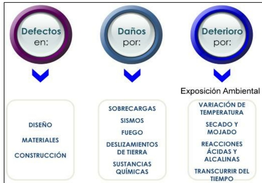
Figura 37, Clasificación general de patologías en las edificaciones
