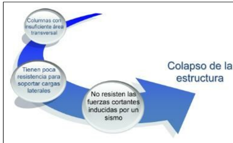
Figura 53, Colapso de la estructura
