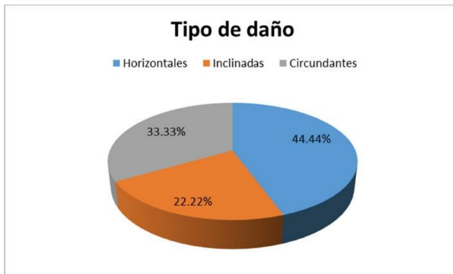
Figura 118. Fallas estructurales en losa – segundo piso
