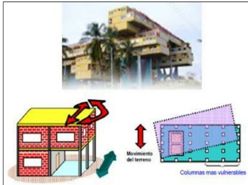
Figura 58, Esquema de efecto de torsión en estructuras asimétricas
