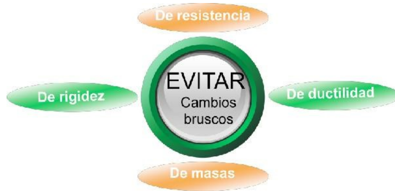
Figura 62, Esquema para evitar cambios bruscos
