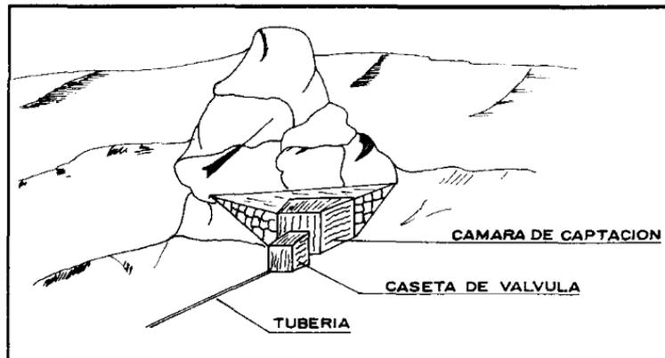
imagen 5 Esquema de captación de agua subterránea
