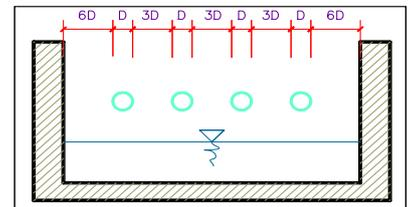
Conocido el número de orificios y el diámetro de la tubería de entrada se calcula el ancho de la pantalla (b), mediante la siguiente ecuación:
