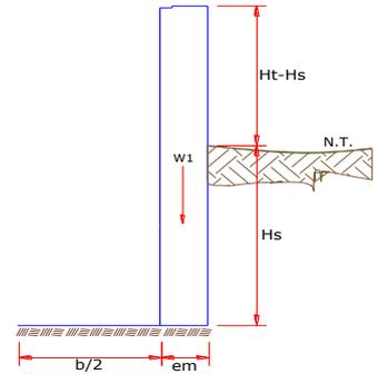
**Empuje del suelo sobre el muro ( P ):**
