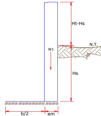
**Empuje del suelo sobre el muro ( P ):**
