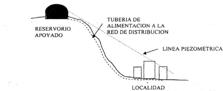
imagen 11 Esquema de reservorio apoyado
