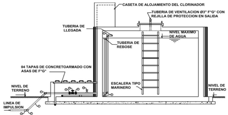
imagen 12 Esquema interno de un reservorio apoyado
