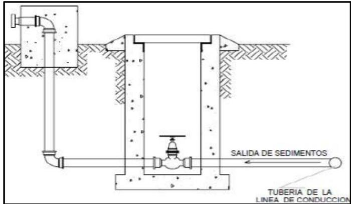
imagen 10 Esquema de la válvula de purga
