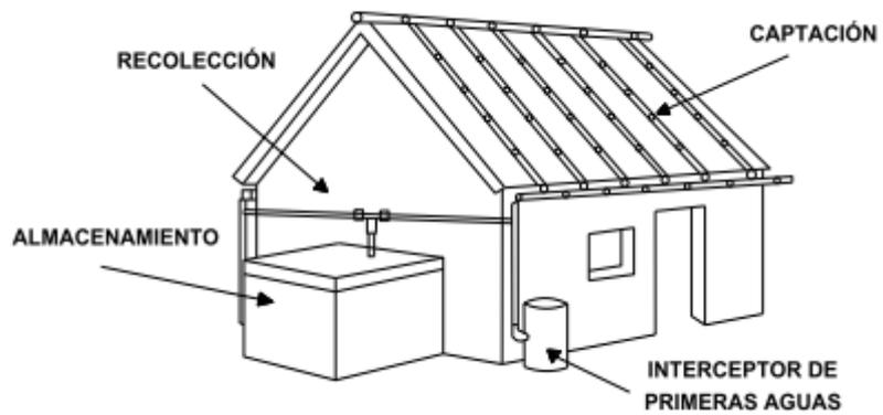
Imagen 3 Componentes de un sistema de captación de agua de lluvia.
