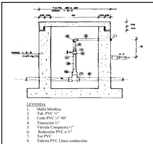
imagen 9 Esquema de la válvula de aire manual
