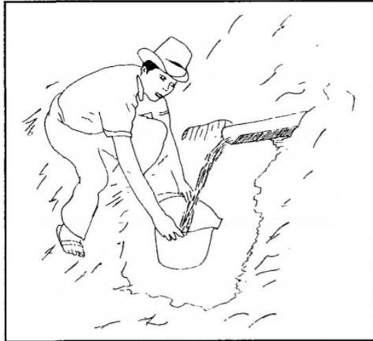
Imagen 2 Aforo de agua por el método volumétrico
