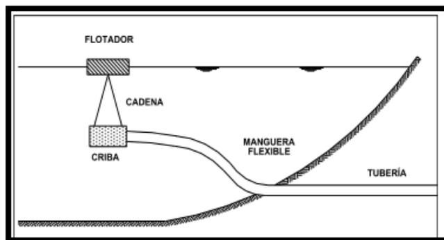
Imagen 4 Esquema de estructura simple de captación de agua superficial.
