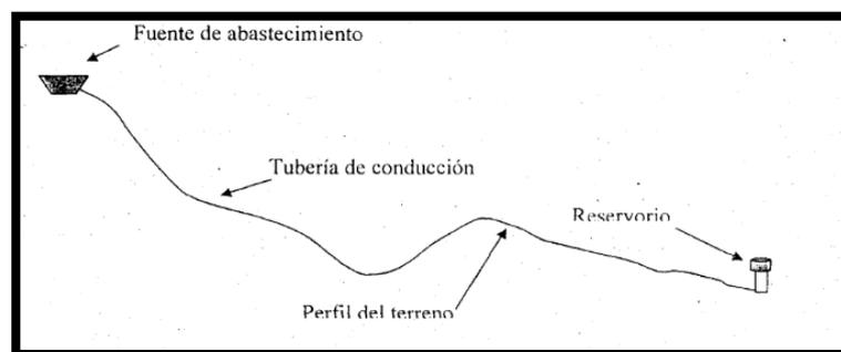
Imagen 8 Esquema de una línea de conducción
