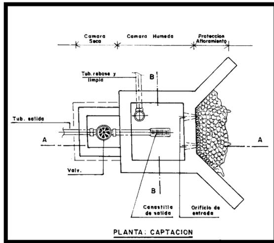
Imagen 6 Cámara de captación de un manantial de ladera y concentrado
