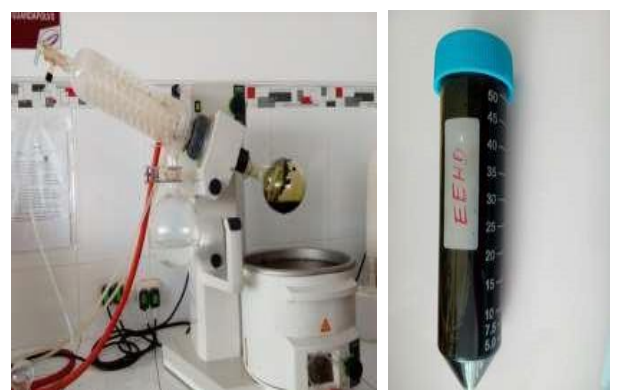
Se llevó el extracto a rota vapor a 40° para eliminar el alcohol.
